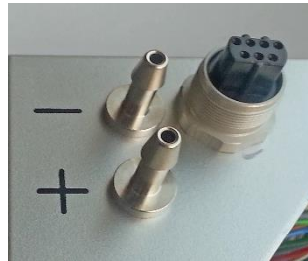
Abb. 3: Differenzdruckanschlüsse und E2-Buchse an Geräteunterseite
